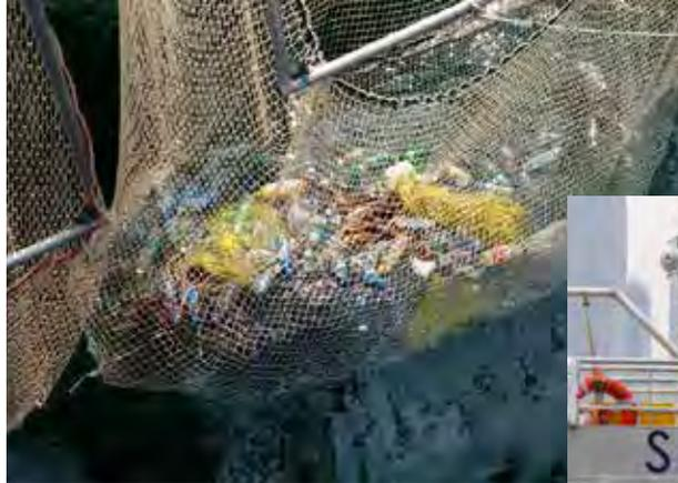
Mithilfe von ausklappbaren Netzen fischt die „SeeKuh“ Plastikmüll in bis zu zwei Meter Tiefe aus dem Wasser.
